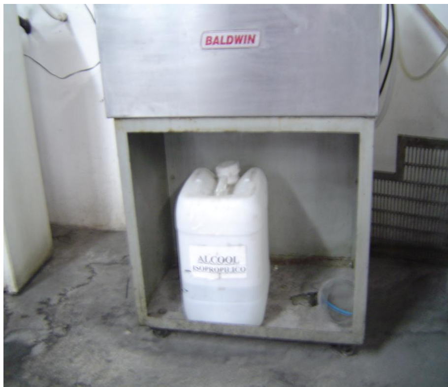
Figura 32: Recipiente de álcool isopropílico semi-aberto.
