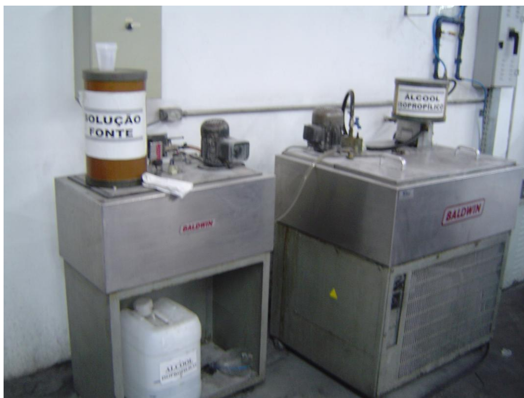
Figura 33: Recipiente de álcool isopropílico perto de equipamento elétrico.
